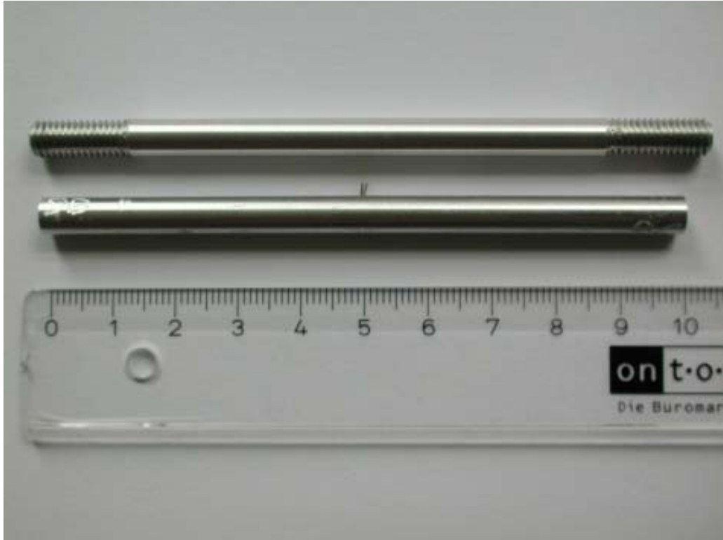
Bild 3: Proben für die Simulation von Warmzugversuch und thermischem Ausdehnungskoeffizienten aus einer Aluminiumlegierung
